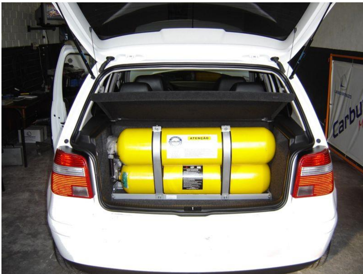
Sele 2.6 Bivalentne auto, mis oli ümberehitatud CNG-le [41]
