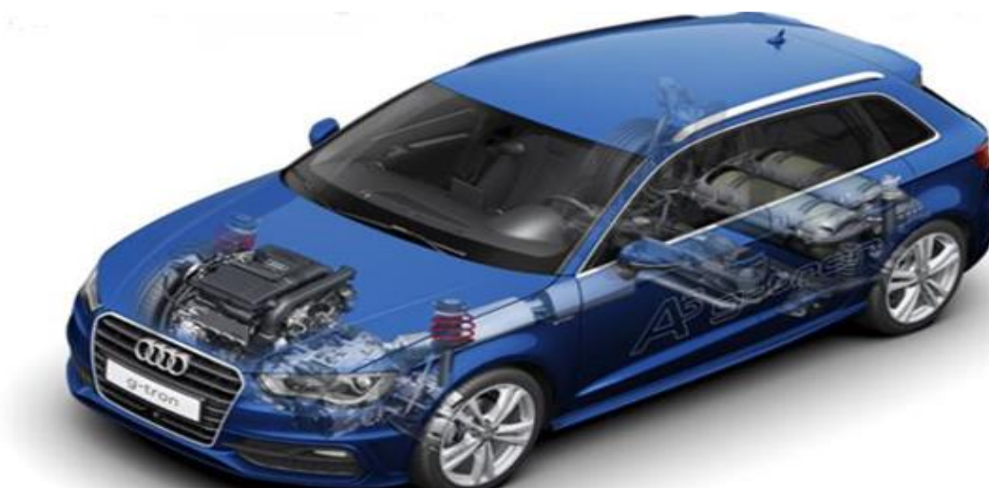
Sele 2.3. Uue Audi A3 bivalentne skeem [37]
