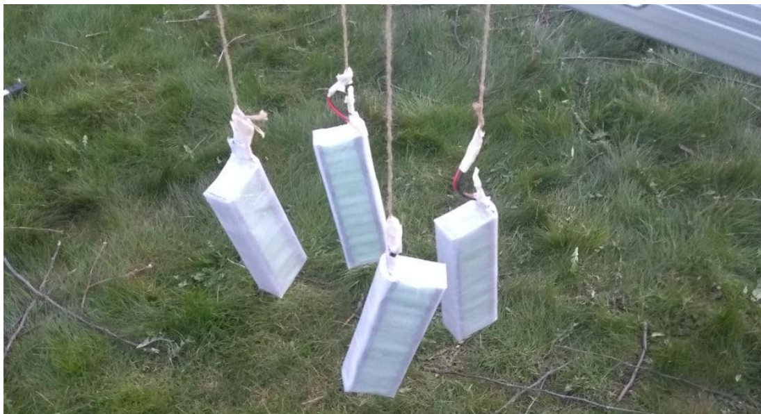
Joonis 2.13 Akupakkide tihendamine kummiühendiga
