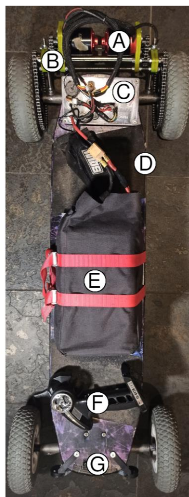
Joonis 2. Maastikurula ehitamisega seotud komponendid, nende asukohad rulal ja neid kirjeldavad peatükid
