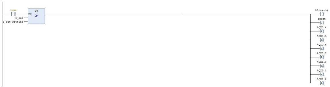
Рисунок 6. Алгоритм отключения всех участков обогрева трубопроводов.
