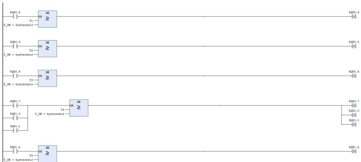
Рисунок 8. Алгоритм выключения обогрева каждого участка трубопроводов.
