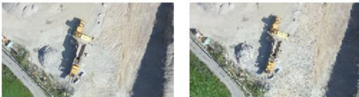
Joonis 1.5 GSD väärtuse võrdlus: vasakpoolsel pildil on GSD väärtus 5cm/px, parempoolsel 30 cm/px [28]
