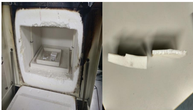
Joonis 2.12 350 °C juures sulanud ja läbipaistvad teflonmaterjali kehad (vasakul) ja samad deformeerunud kehad pärast ahjust välja võtmist toatemperatuuril
