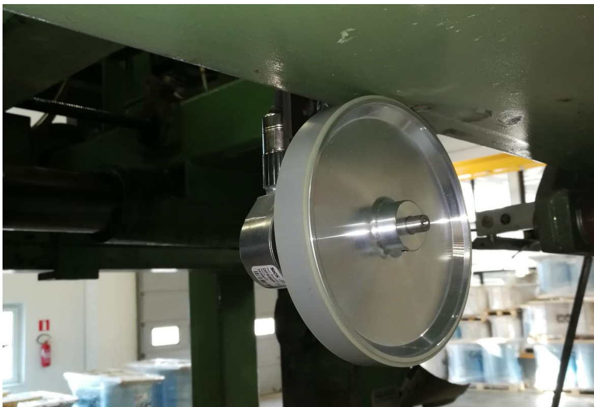
Joonis 3.8 DFS60B-BHPA10000 enkooder koos mõõterattaga
