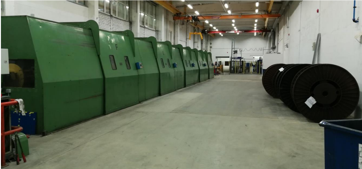
Joonis 1.7 Keerutusseade koos trumlitega
