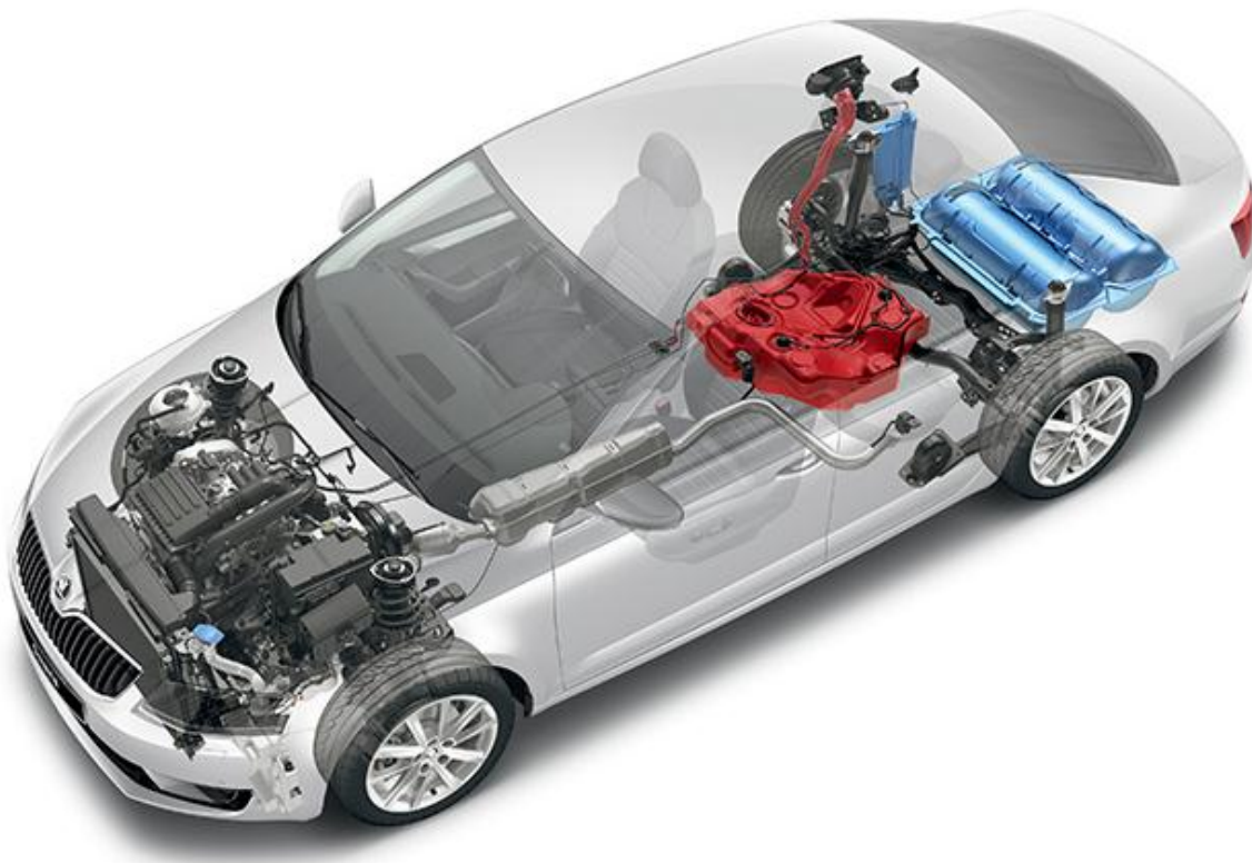
Sele 2.3 Škoda Octavia CNG skeem 9
