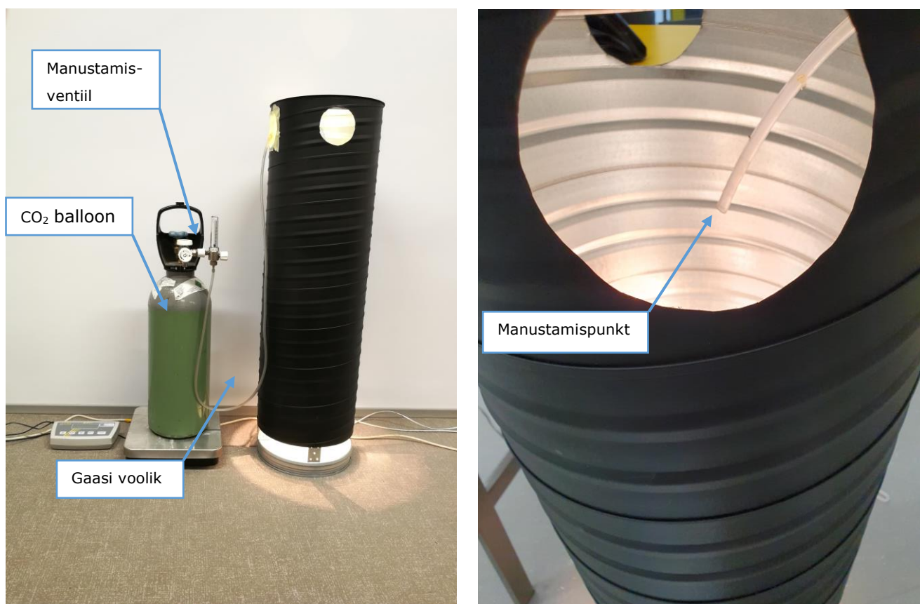
Joonis 8 – CO 2 allikas (vasakul) (autor Martin Kiil), gaasi manustamise punkt (paremal)
