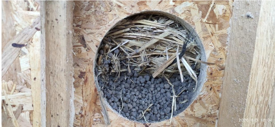
Joonis 48. Auk uputuse läbinud katsekeha karkassis (6 päeva pärast uputust)
