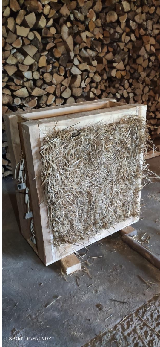
Joonis 31. Katsekeha on valmis trimmimiseks. Lühema külje pealt paistavad ka kolm logerit.
