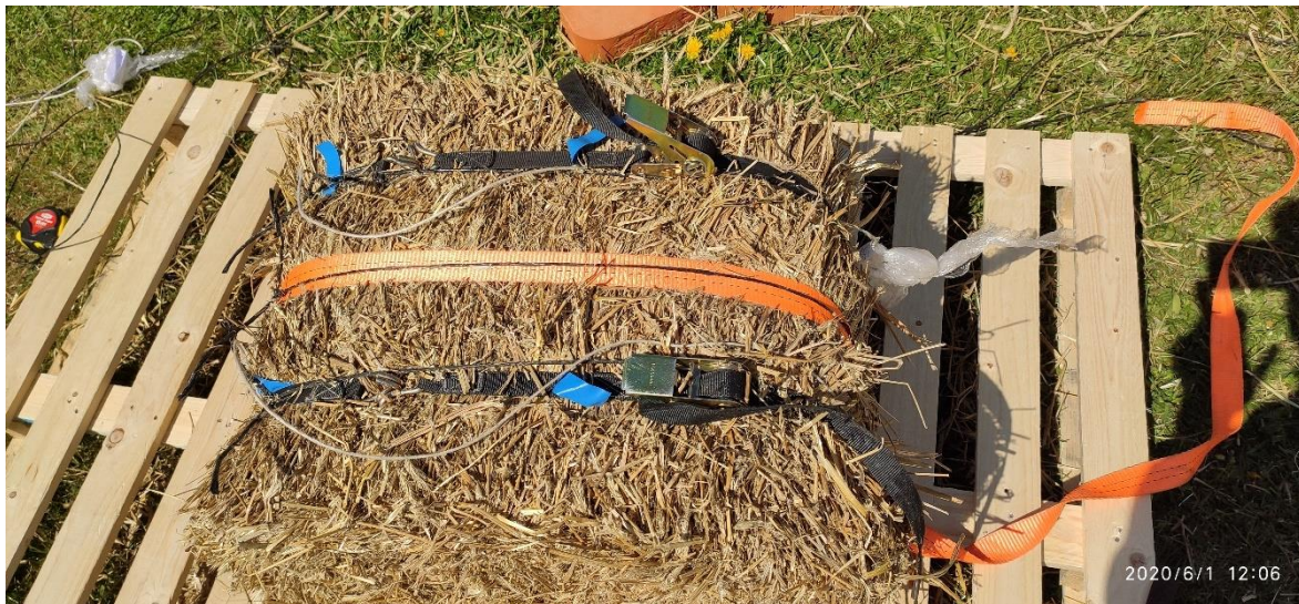
Joonis 28. Pakkide tihendamine koormarihmade abil. Pildil on näha ka musta värvi uued pakinõõrid.
