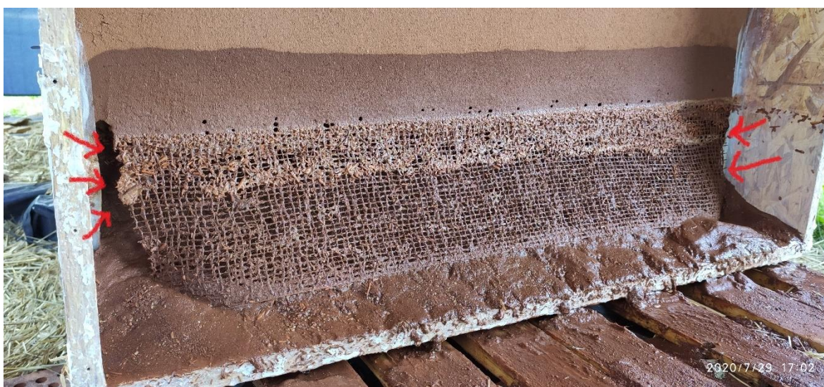
Joonis 63 Punaste nooltega on näidatud vee esmased lekkesuunad.
