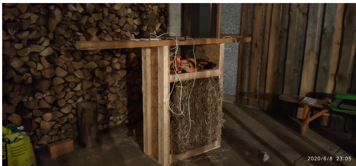
Joonis 29. Katsekeha karkass, kus on näha ka alumise vöö vahel olevat kergkruusa
