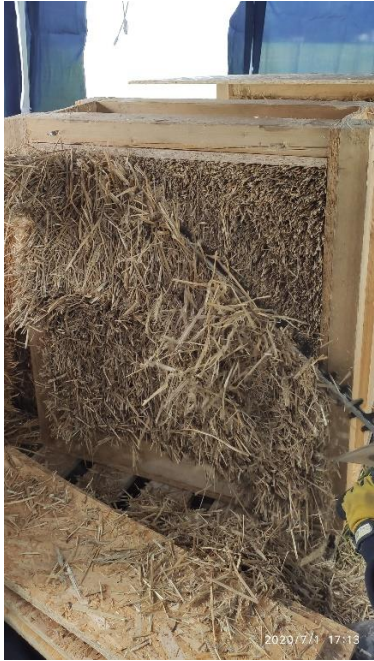
Joonis 32. Katsekeha trimmimine.
