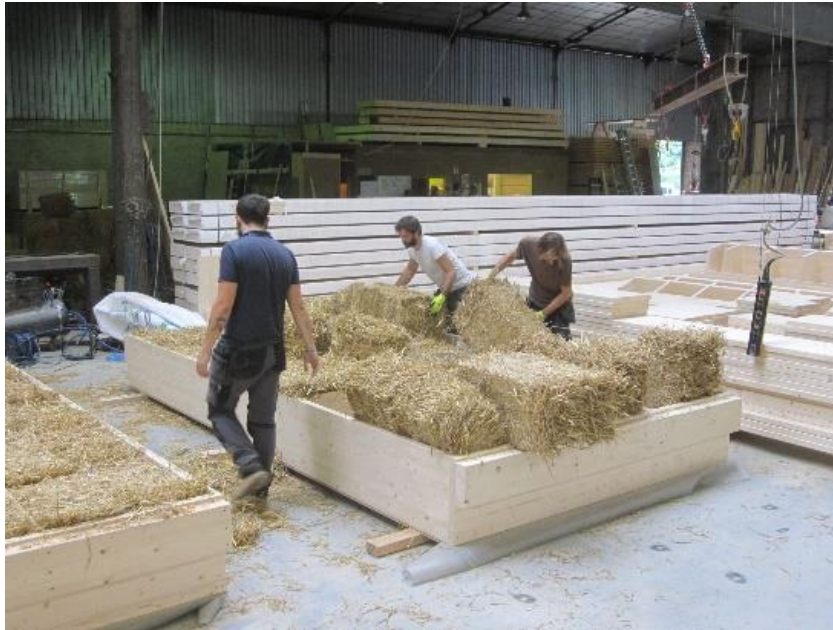
Joonis 22. Paneelide valmistamine [26].
