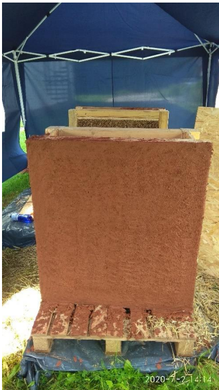
Joonis 34. Värskest paigaldatud nakkekrohv
