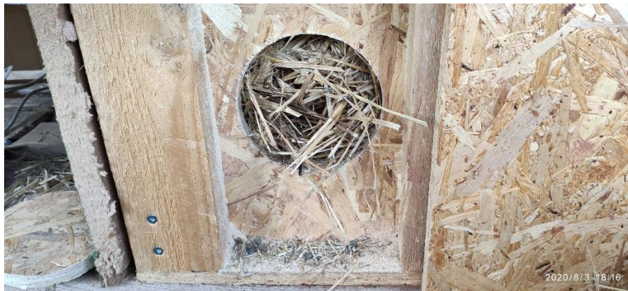
Joonis 49. Auk kuivana seisnud katsekeha karkassis
