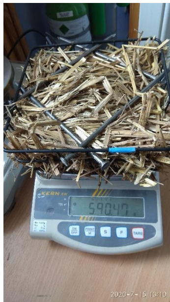
Joonis 43. Veeimavuse katsekeha kaalul
