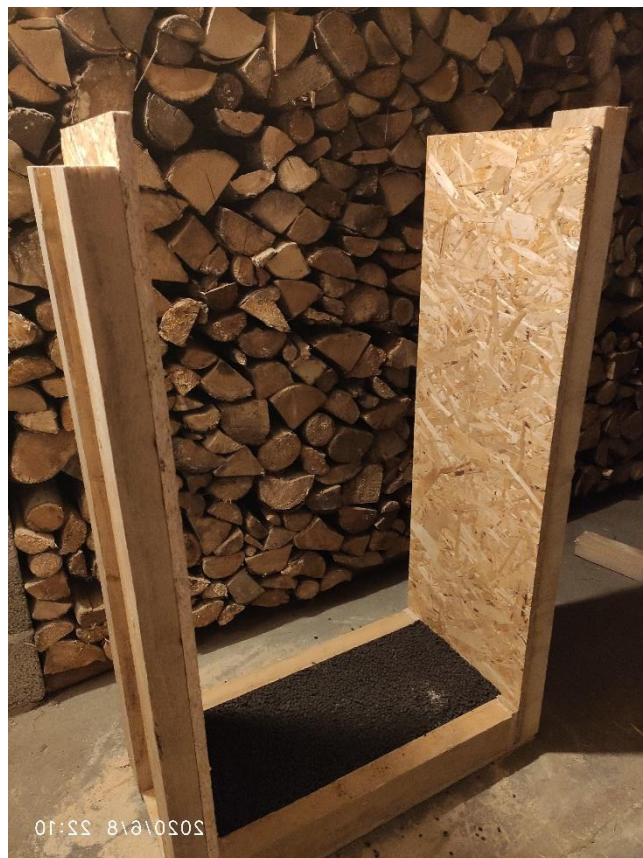
Joonis 29. Katsekeha karkass, kus on näha ka alumise vöö vahel olevat kergkruusa
