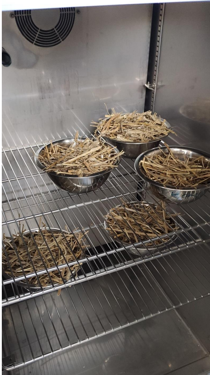
Joonis 45. Põhu sorptsioonikatsed kliimakambris.
