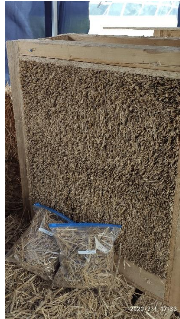
Joonis 33. Trimmitud katsekeha
