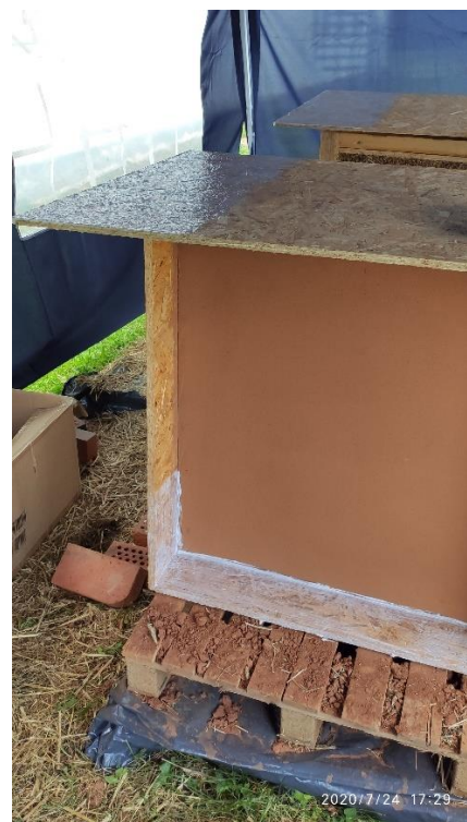
Joonis 39. Katsekeha siseruumi alumine osa kaeti vee tõkestamiseks värviga
