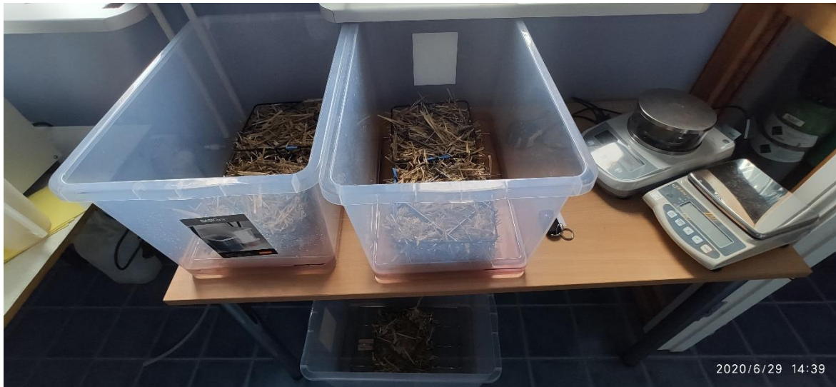
Joonis 44. Põhu veeimavuse katsekehad osaliselt uputatuna.
