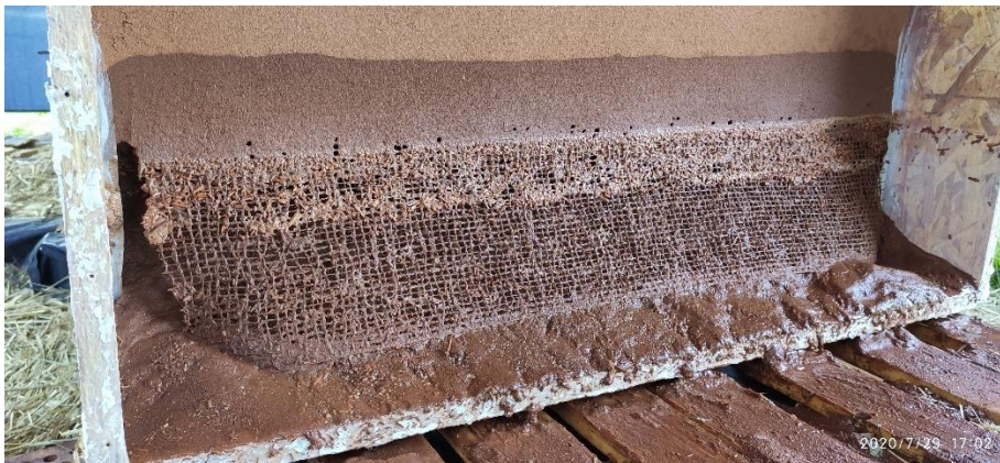
Joonis 46. Nähtavad veekahjustused peale uputust.
