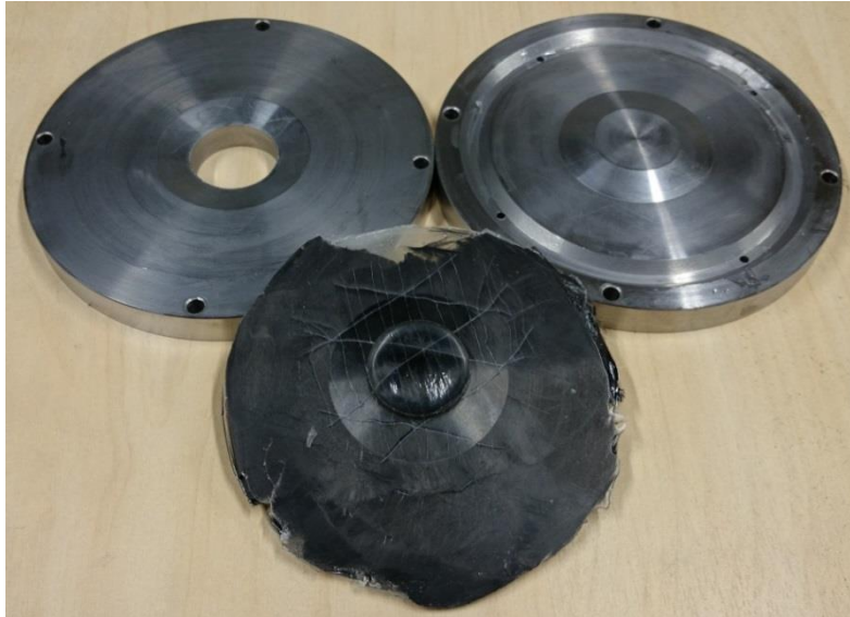
Sele 5.16 Prototüüpvorm ja vormist eemaldatud vedrutaldriku toorik
