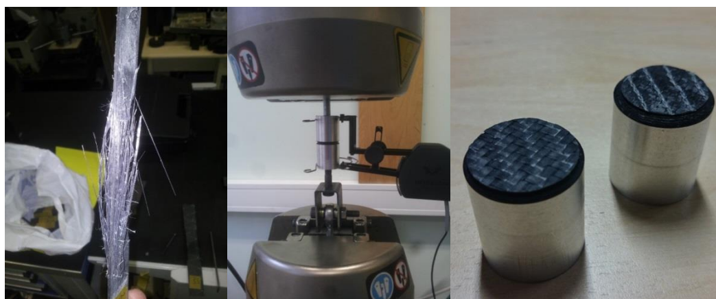
Sele 4.5 UD purustatud katsekeha (vasakul), Z-telje suunaline tõmbekats (keskel) ja purustatud katsekeha (paremal) [8]
