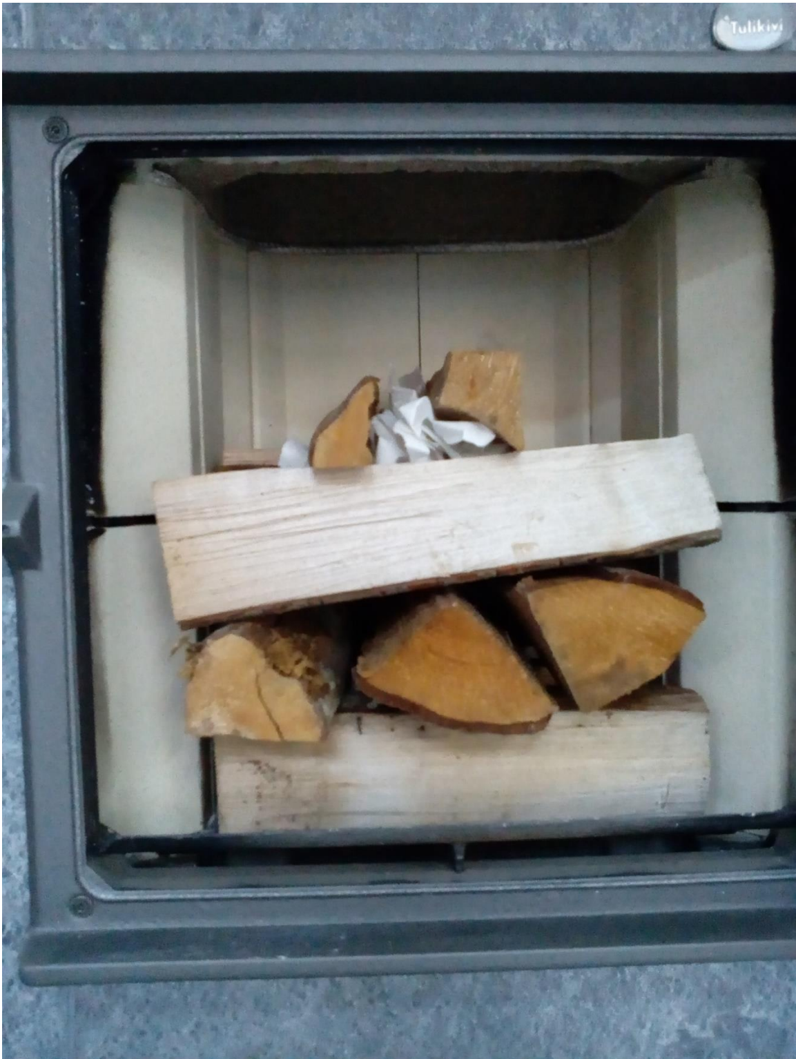
Joonis 6 Näide risti laotud puudest, representiivseks pildiks on võetud 15.03 tehtud esimese katse jaotus, millega mõõdeti statsionaarse olukorra heitmeid külma aju kütmisel
