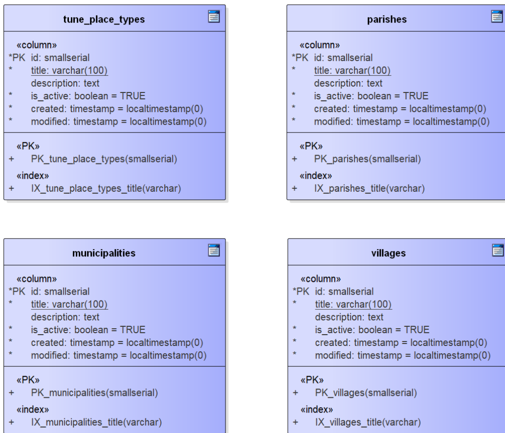
Joonis 72. Klassifikaatorite registri füüsilise disaini andmebaasi diagramm kohtade klassifikaatorite kohta.
