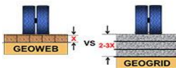
Joonis 7.1 Konstruktsiooni paksuse võrdlus geokärje ja geovõrgu vahel [14]
