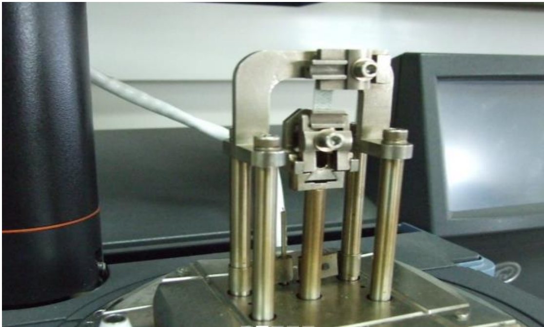
Joonis 8.3 Dünaamiline test polümeeridele [18]
