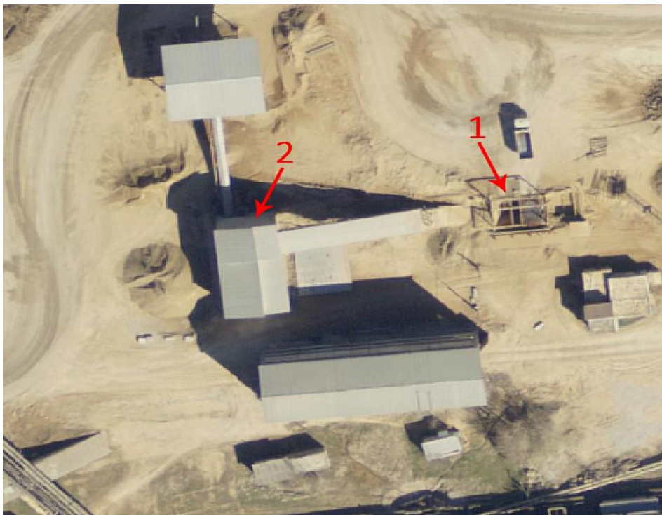
Sele 3.1. Põlevkivi vastuvõtu ja ettevalmistamise sõlm: 1 - sõelaga vastuvõtupunker, 2- ettevalmistamise sõlm [2].
