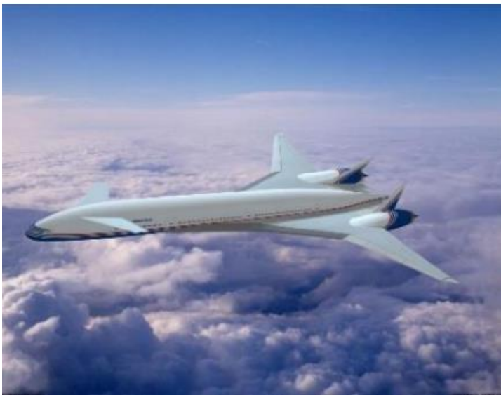
Joonis 2. Segatud tiivakerega lennuki disain
