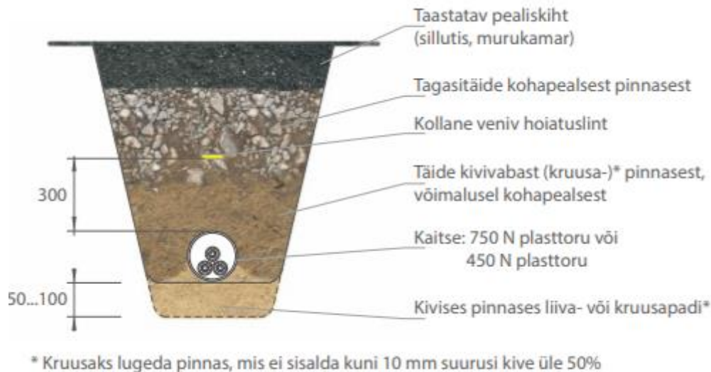
Joonis 2.6. Lõige kaablikaitsetorust ja kaablist kaevises. [16]
