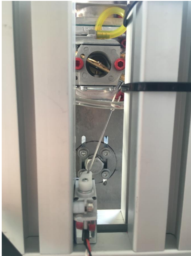
Joonis 7.1.2 Servomootori kinnitamine
