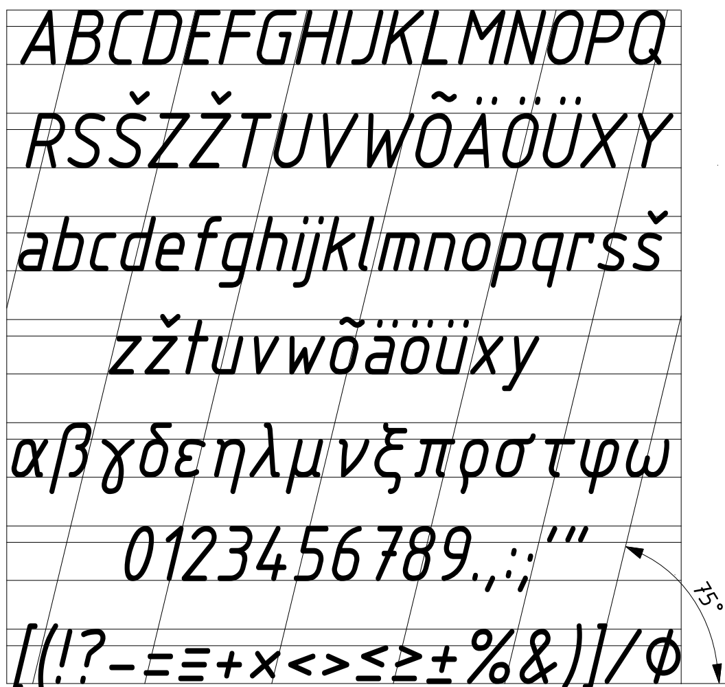
Joonis 1.17. Ladina tähestiku, märkide ja numbrite B-tüüpi kaldkiri ISO-3098-1 järgi.
