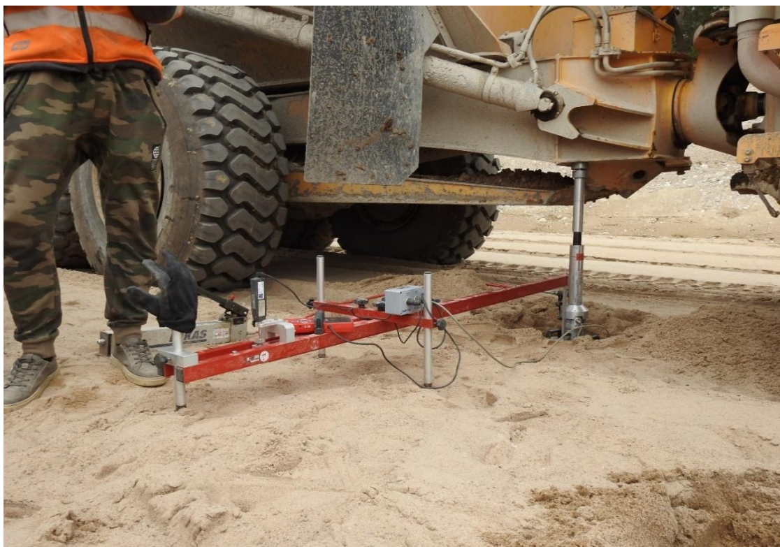
Joonis 6.1: Plaatkoormuskatse seade mõõtmisolukorras, kus vastu raskuseks on valitud rasketehnika
