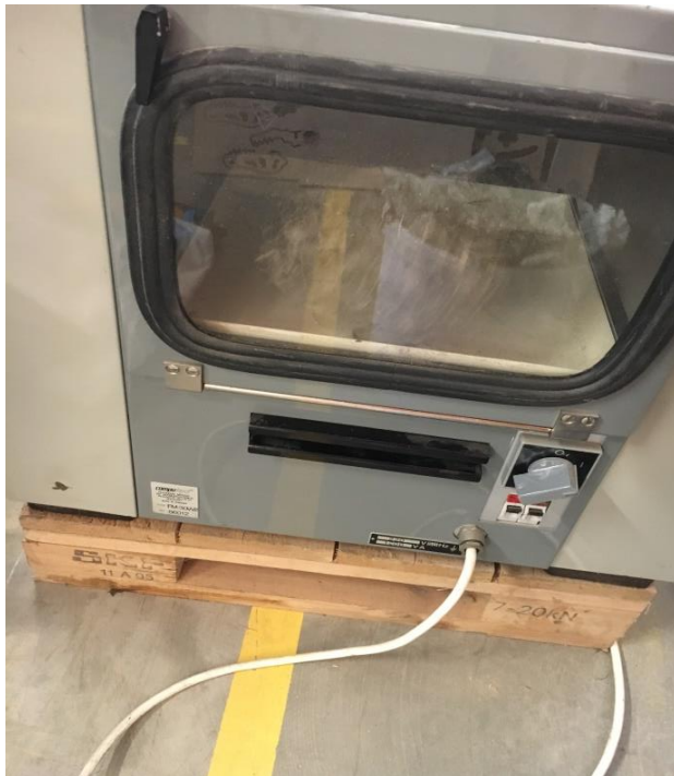
Joonis 2.3 Villapuhastusmasina puhtakiu kogumiskast
