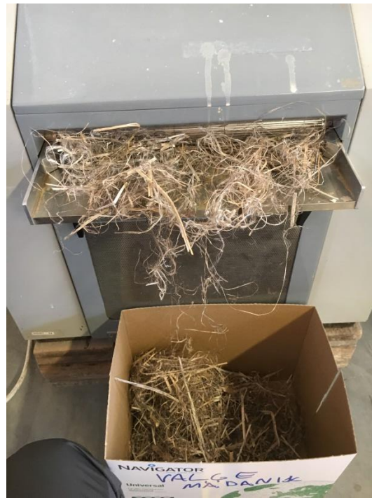
Joonis 2.4 Villapuhastusmasinasse kanepi panemine
