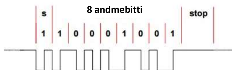
Joonis 2.12 DALI andmetagastuspaketi ( backward frame ) vorming [23]
