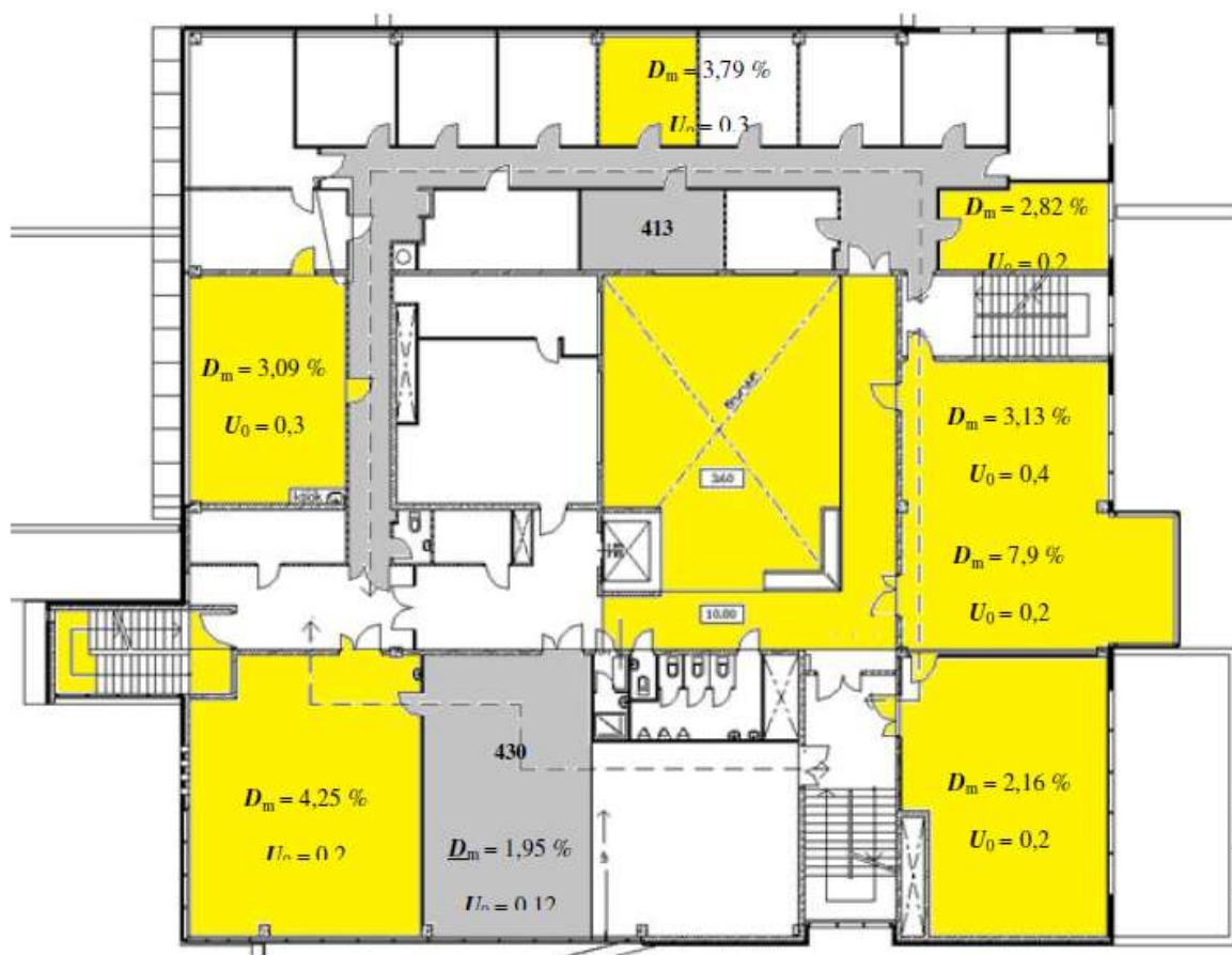
Joonis 3.1 Ruum NRG-430 asukoht korruse plaanis [30]
