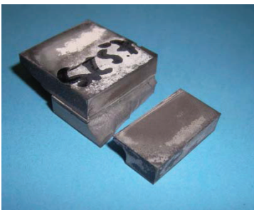
Bild 5.32 Bruchbild des Verbundes SSN / Folie F04 / SSN; T_F = 1700 °C; t_H = 30 min [88]
