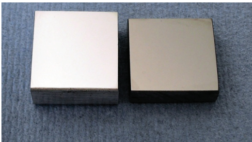
Bild 4.5 Präparierte Oberflächen der Fügewerkstoffe; AlMg3 (a); X5CrNi18-10 (b) [87]
