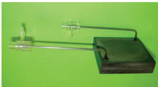
Sele 7. Liidetetehnoloogia abil valmistatud AlN soojusvaheti mõõtmetega 50 x 50 mm 2
