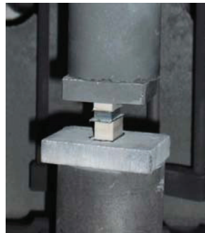
Bild 4.11 Fügeanordnung mit positionierten Pressstempel [89]
