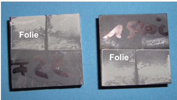
Bild 5.33 Bruchbild des Verbundes SSN / Folie F22 / SSN; T_F = 1500 °C; t_H = 30 min [88]
