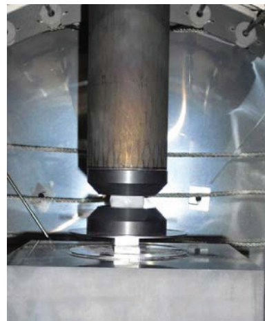
Bild 4.15 Fügeanordnung mit positionierten Pressstempel [87]
