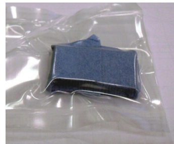
Bild 4.5 Vakuumdicht verpackte Probe [87]
