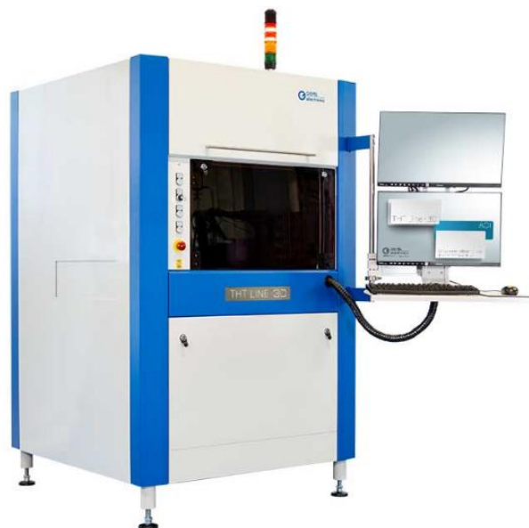
Joonis 3-2 GÖPEL THT Line - 3D [28]
