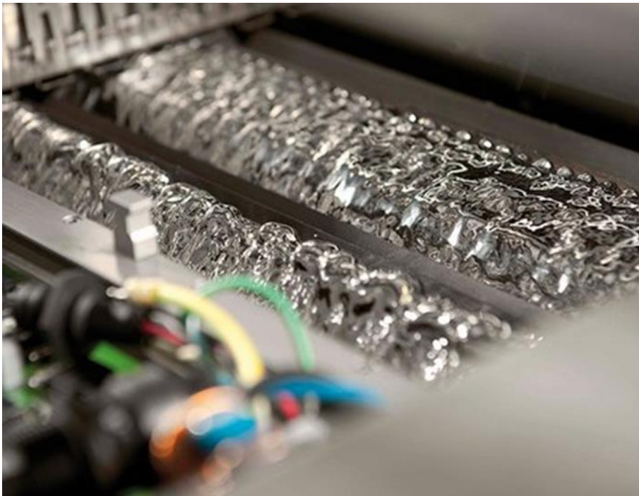
Joonis 1-1. Kurtz Ersä lainejootemasin [15]
