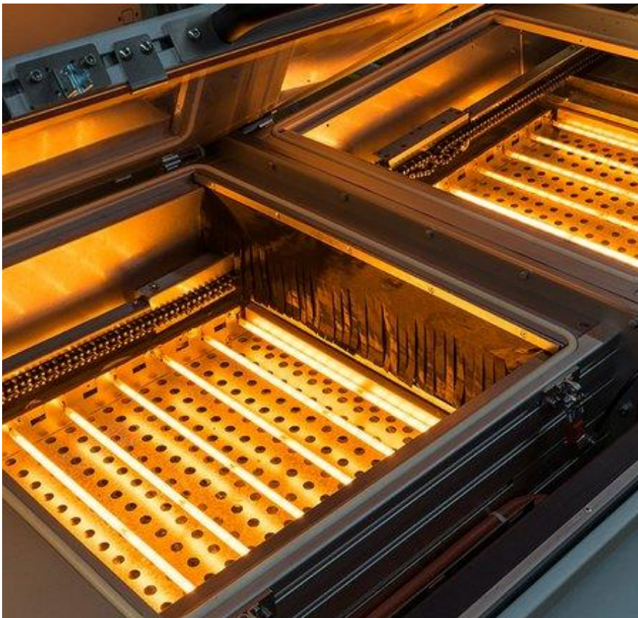
Joonis 1-3. Kurtz Ersa eelsoojendus lainejootemasinas [15]
