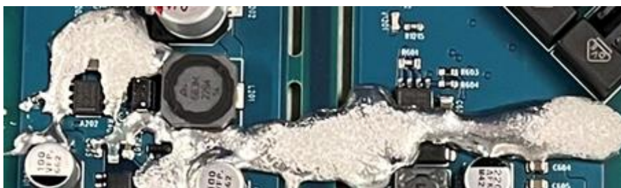
Joonis 1-4. Trükkplaadile valgunud joodis
