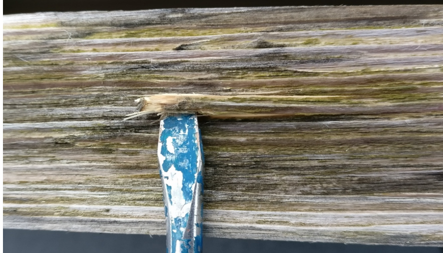
Joonis 4.1 Pick-testi tulemus COST FP1303 projekti katsekehal B1
