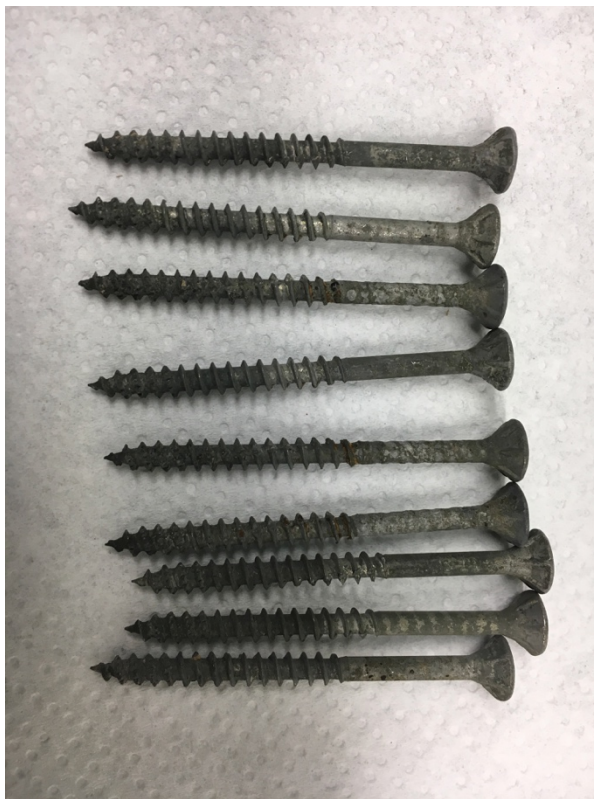
Joonis L7.0.3 Kruvide puhastamine kuumas vees
