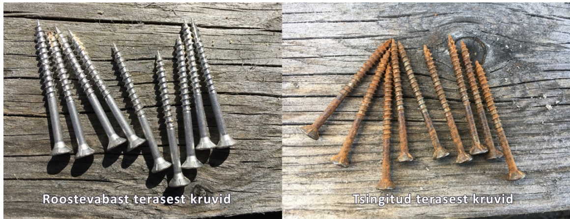
Joonis 4.5 (Vasakul:) Imprest AS katsekehades korrodeerumata roostevabast terasest kruvid (hinne "0") ja (paremal:) täielikult korrodeerunud tsingitud terasest (hinne "4")
