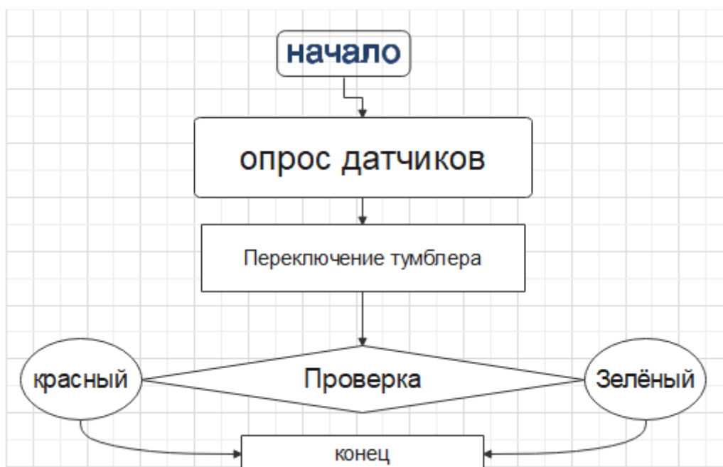
Рисунок 6.1.2. Алгоритм управления светофором
