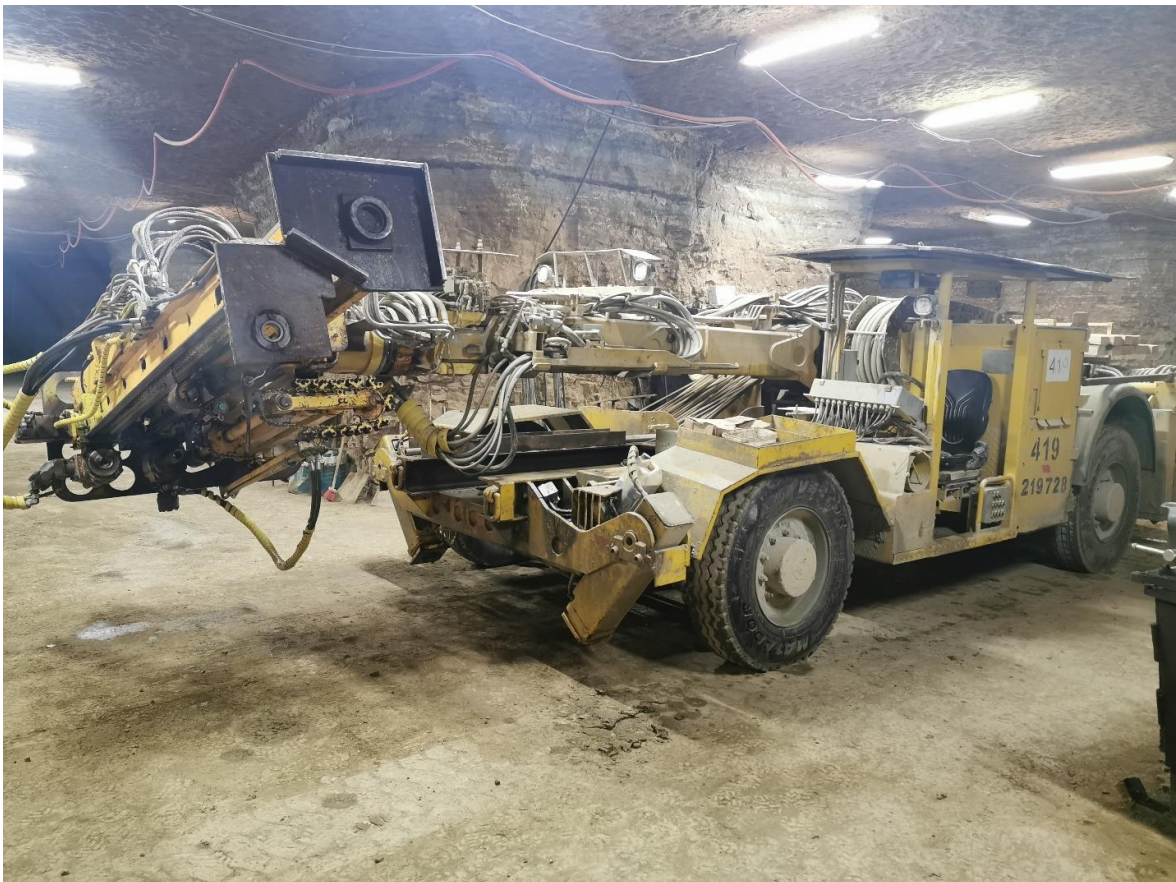
Joonis 4. Laeankuraukude puurseade SMAG FA-523V (FA-523VED)
