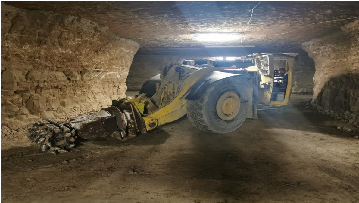
Joonis 8. Rookimismasin ERKAT ST1030
