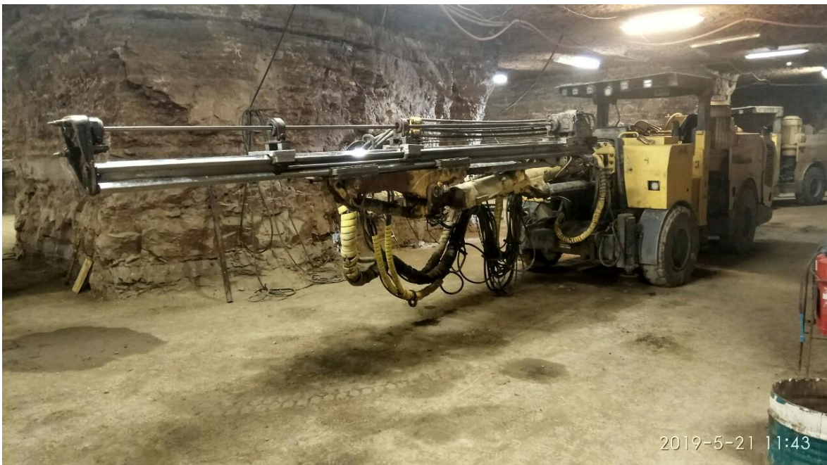
Joonis 6. Lühkeaukude puurimisseade Boomer S1D
