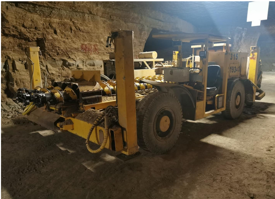
Joonis 5. Algmurde puuraukude puurseade SMAG GB 280/4.7
