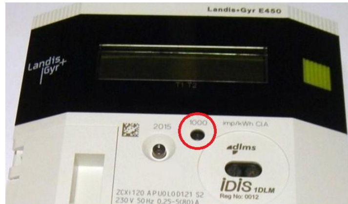
Joonis 4.1 Ringiga tähistatud valgusdiodid tüüpilisel kaugloetaval arvestil [20]
