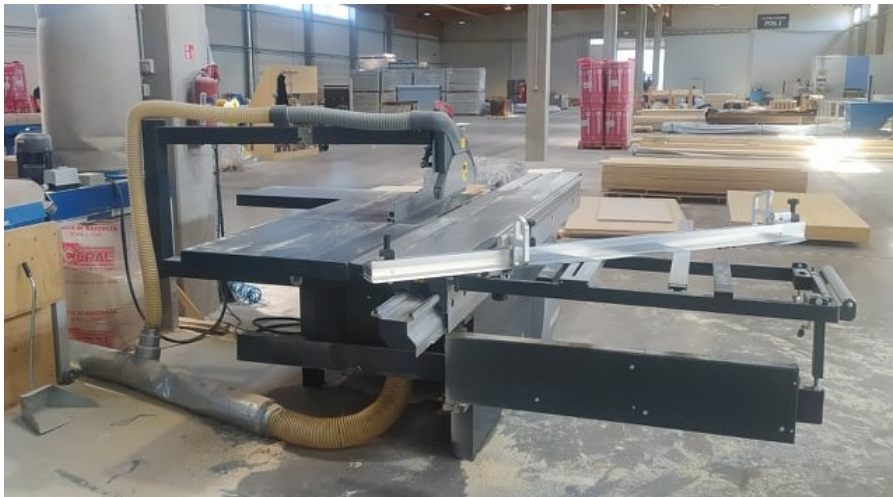
Joonis 2.8 Plaatide lõikamise masin Altendorf Welement AS tehases
