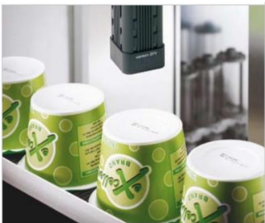
Рис. 5 Проверка напечатанной информации об изделии на высокоскоростной линии упаковки [9].
