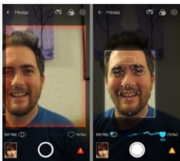
Рис. 9 Мобильного приложение Verity детектирует лицо и распознает “мимические точки” для отслеживания мимики по видео [10].
