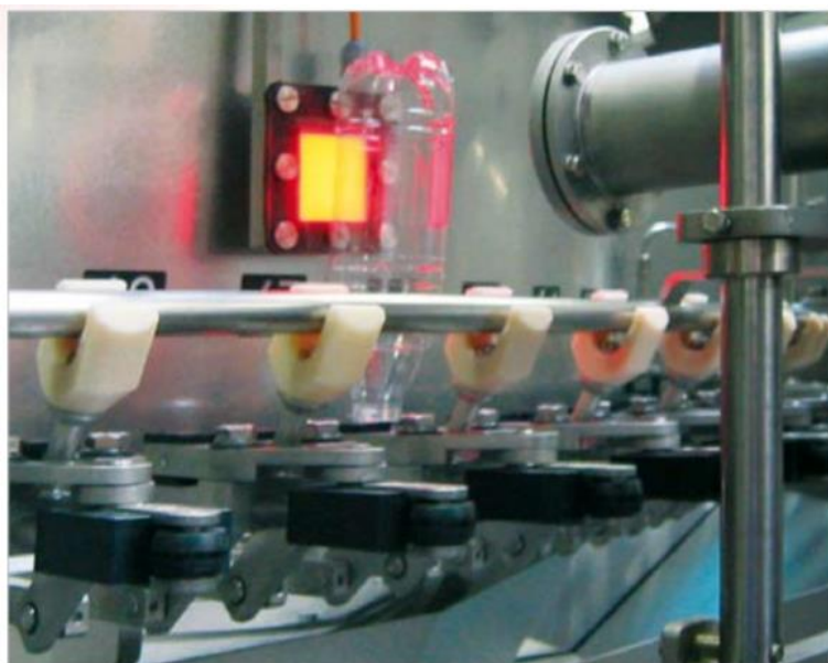
Рис. 6 На линии высокоскоростного розлива напитков датчик F160 проверяет чистоту бутылок перед их заполнением [9].
