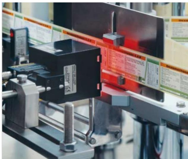
Рис. 7 Термопринтер печатает этикетки для фармацевтических препаратов с различными сроками годности и номерами партий [9].
