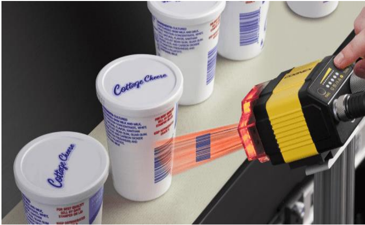
Рис. 8 Применение машинного зрения для чтения маркировки и контроля качества продукции и упаковки [9].
