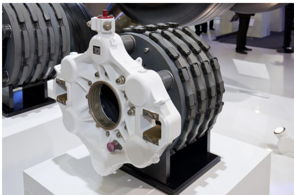
Joonis 1. Lennunduses kasutatav süsinikust pidurisüsteem [4].
