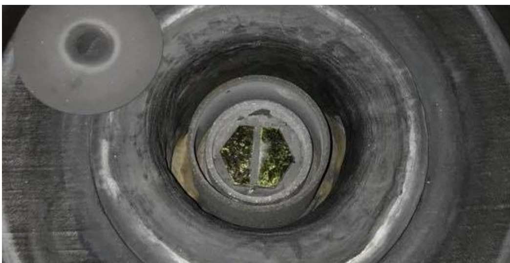
Joonis 18. Green body detailid pürolüüsahjus enne protsessi.
