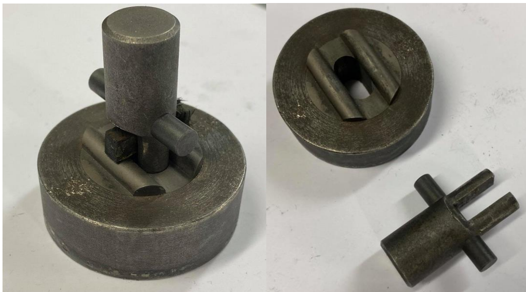
Joonis 25. Kolme punkti katserakis kasutamiseks kolme punkti painde katsetusteks Instron katseseadmes.
