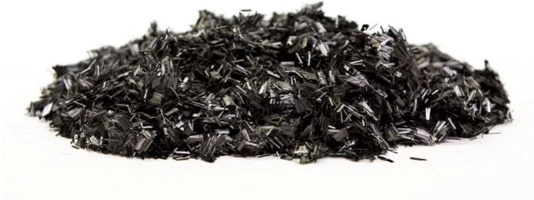
Joonis 9. Tükeldatud süsinikkiud ehk staapelkiud [15].
