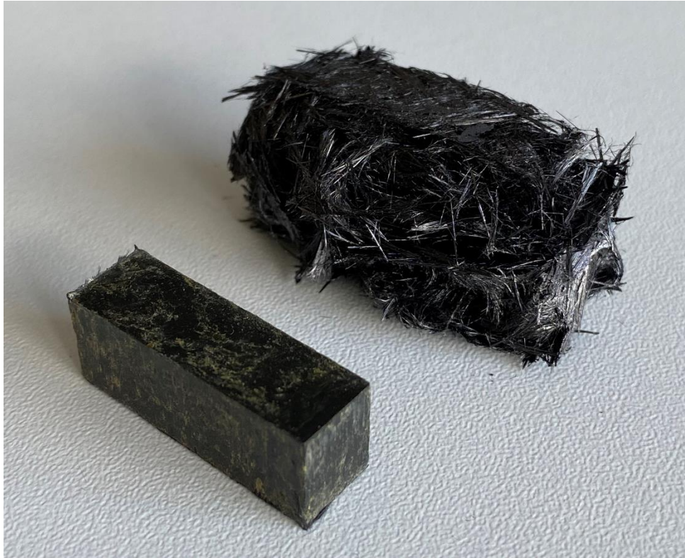
Joonis 11. Tooriku defekti näide enne ja pärast pürolüüsi. Green body (vasakul), Pürolüüsi käigus tekkinud tooriku paisumine (paremal).
