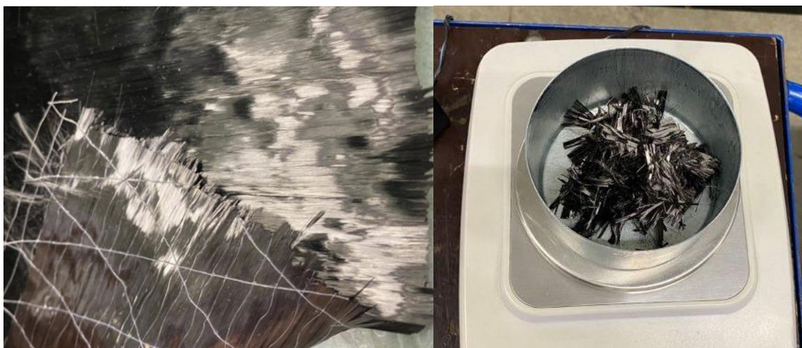
Joonis 17. Kasutatud ühesuunaline süsinikkangas ja tükeldatud süsinikkiud.
