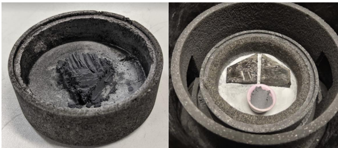
Joonis 21. Detailid enne pürolüüsitsükli ahjus. Vasakul detail ja räni kontaktis. Paremäl räni eraldi keraamilises anumamas.
