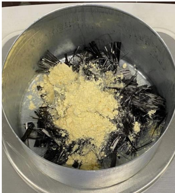
Joonis 14. Kokku segatud fenoolvaik ja tükeldatud süsinikkiud.
