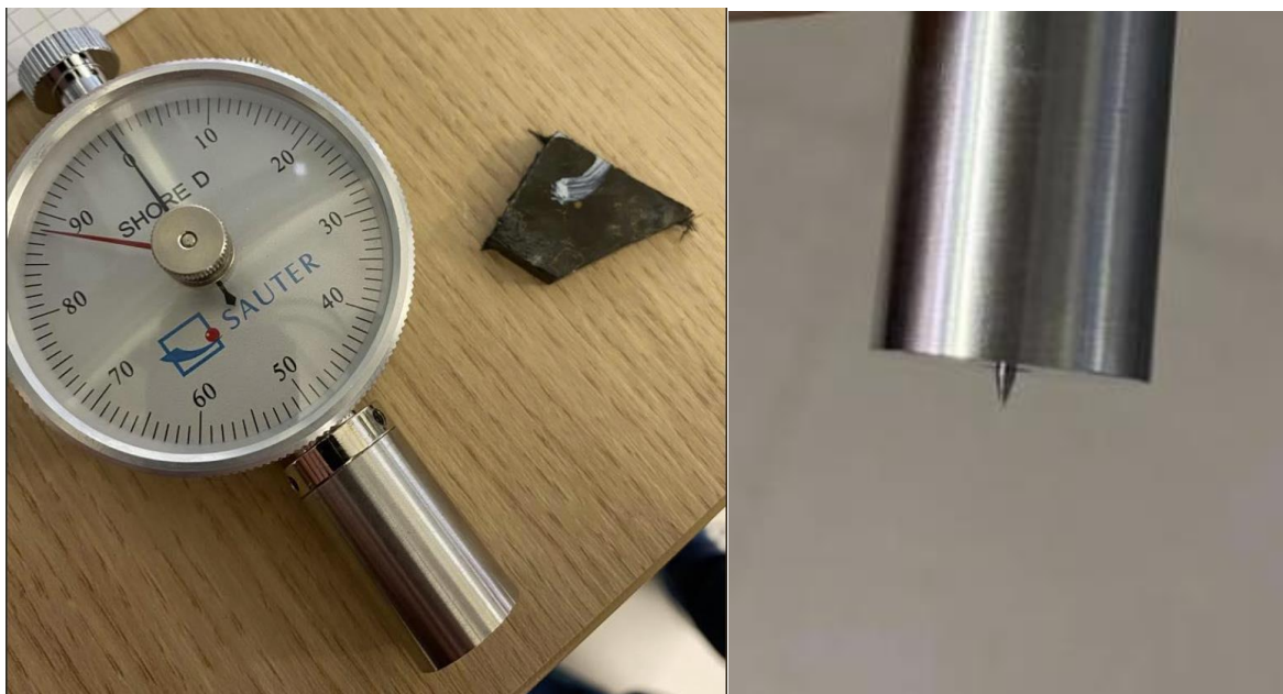
Joonis 26. Shore D duromeeter (vasakul) ja selle indenter (paremal).
