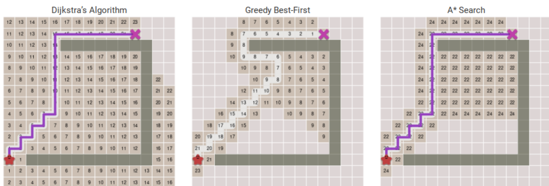
Joonis 17: Dijkstra algoritm (vasakul); Greedy Best-First Search (keskel); A* algoritm (paremal) [24]
