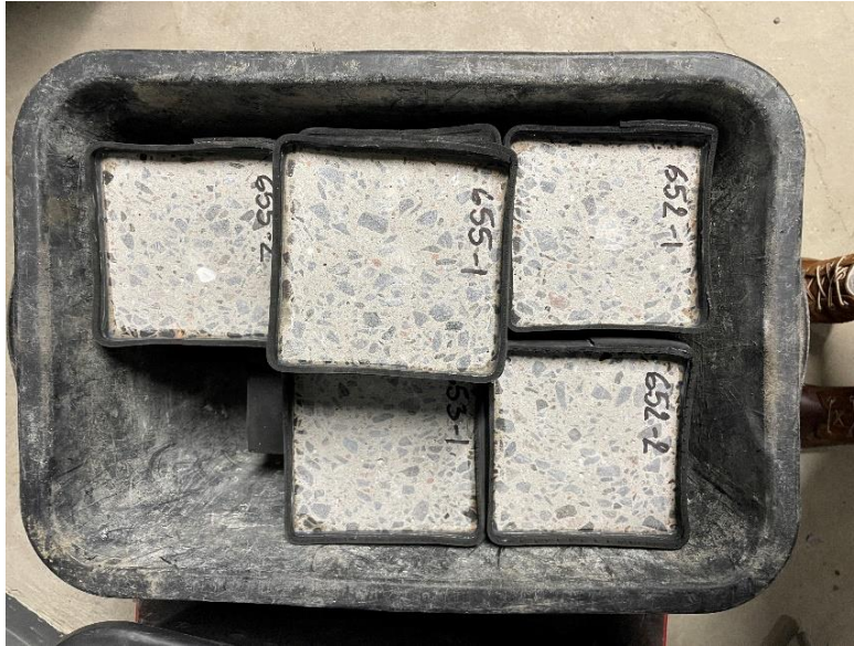
Joonis 2.5 Külmakindluse katseks ettevalmistatud katsekehad [autori erakogu]
