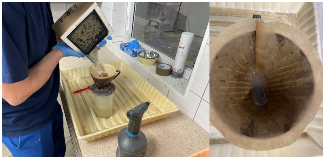
Joonis 2.8 Katsekeha puhastamine pärast külumumismõõtmisi [autori erakogu]
