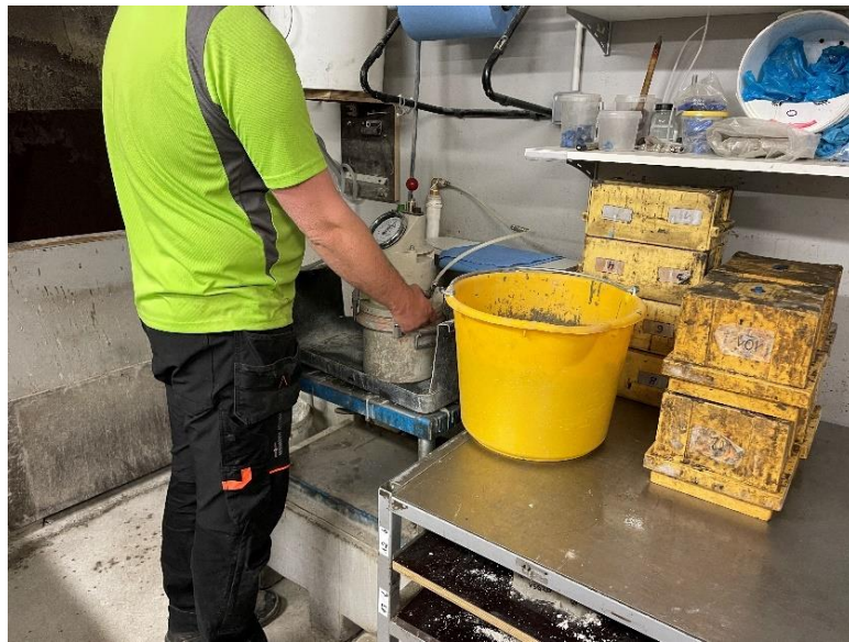
Joonis 2.4 Betooni õhusisalduse mõõtmine rõhumeetodil [autori erakogu]
