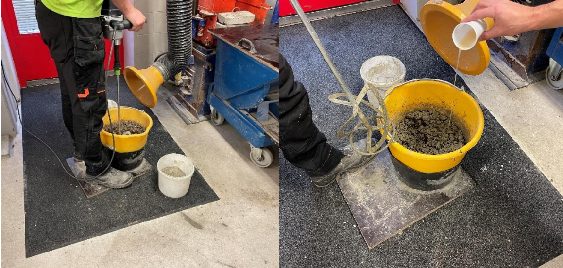
Joonis 2.2 Betooni koostisosade segamine [autori erakogu]
