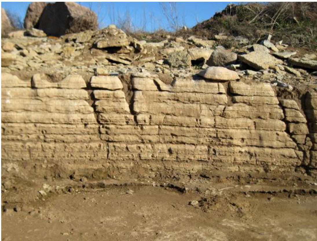
Joonis 10. Geoloogilise häirituse mõju lõhketööle (Einasto, 2013).
