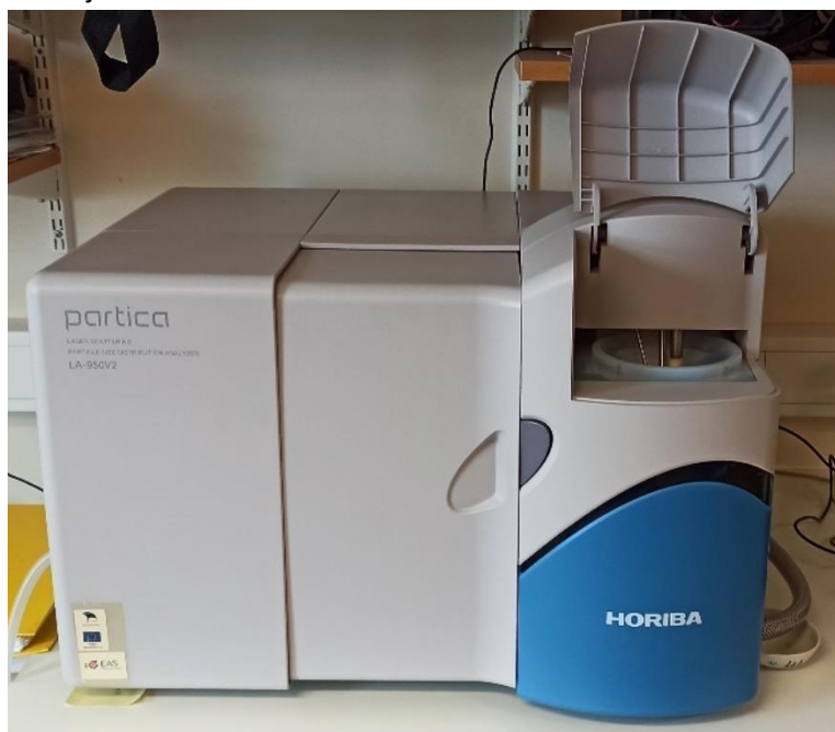
Joonis 23. Laserdifraktsioon analüüsi katseseade Horiba LA-950 (Autori foto)
