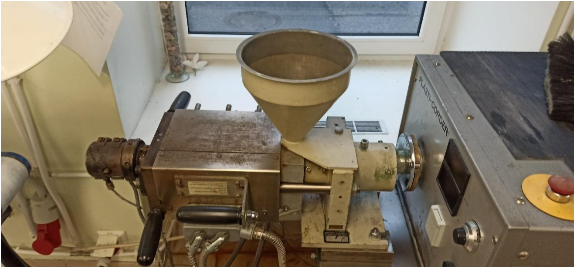
Joonis 17. Kaheteoline ekstruuder BRABENDER PLASTICORDER PLE651 (Autori foto)
