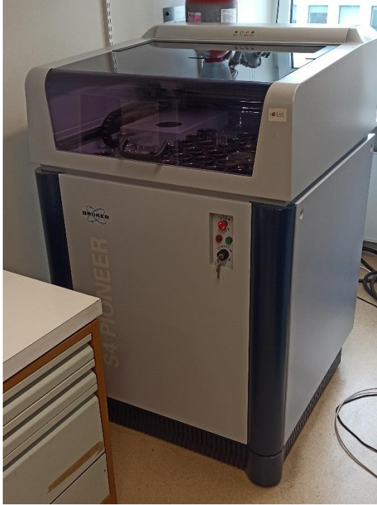
Joonis 24. XRF analüüsi katseseade Bruker S4 Pioneer WDXRF (Autori foto)
