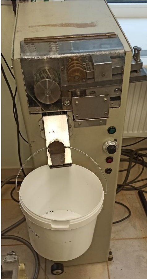
Joonis 19. Filamendi granuleerimis seade BRANBENDER (Autori foto)
