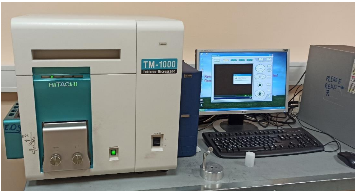
Joonis 25. Skaneeriva elektronmikroskoop Hitachi TM1000 (Autori foto)
