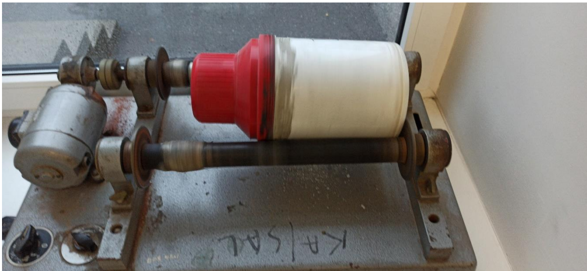
Joonis 16. Polümeeride ja tekstiilitehnoloogia labori trummelsegisti Groschopp DM 40-60 (Autori foto)
