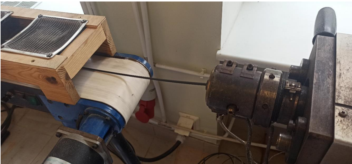
Joonis 18. Filamendi liikumine kompaundierist lintkonveierile (Autori foto)
