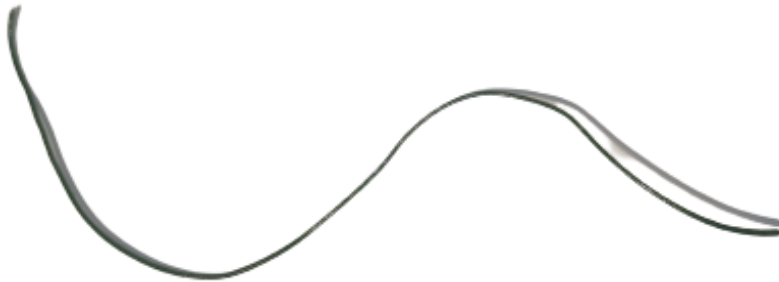
Joonis 30. 60 sekundi jooksul kapillaarist välja voolanud filament ( Autori foto)
