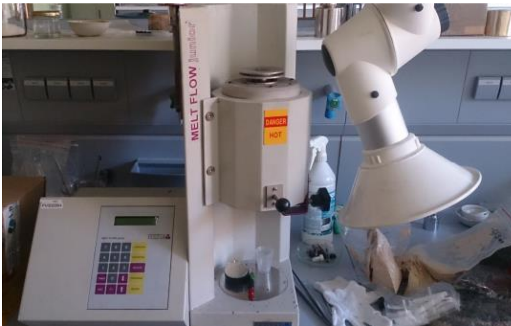
Joonis 29. Sulandi voolukiiruse katseseade CEAST Melt Flow Junior (Erakogu).
