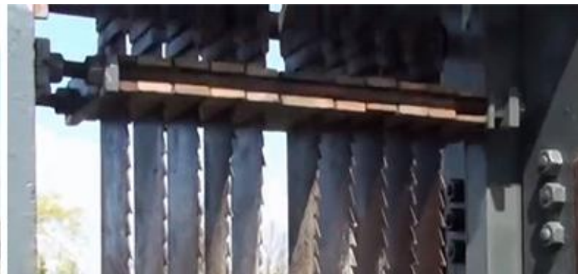
Joonis 3.7. Konstruktsioon saelehtede ristisuunaliseks fikseerimiseks ja lehtede vahede kalibreerimiseks [18]
