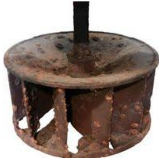
Joonis 2.4. Hoolduseks eemaldatud Ledyard'i saeveski turbiini rootor aastal 2013 [12]
