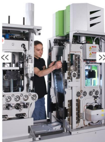
Joonis 4.3. Avatav masina konstruktsioon kiireks ja mugavaks saeraami vahetuseks [30]
