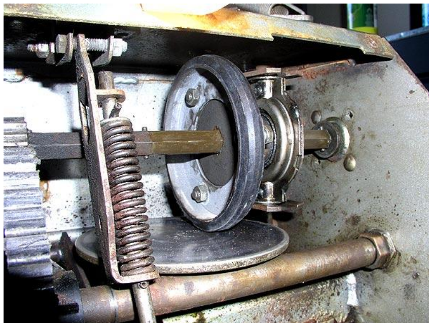
Joonis 3.15. Näide friksioonülekandest lumepuhuril [20]
