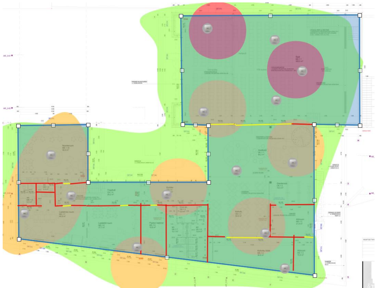
Joonis 4. Traadita kohtvõrgu pääsupunktide jaotus esimesel korrusel.
