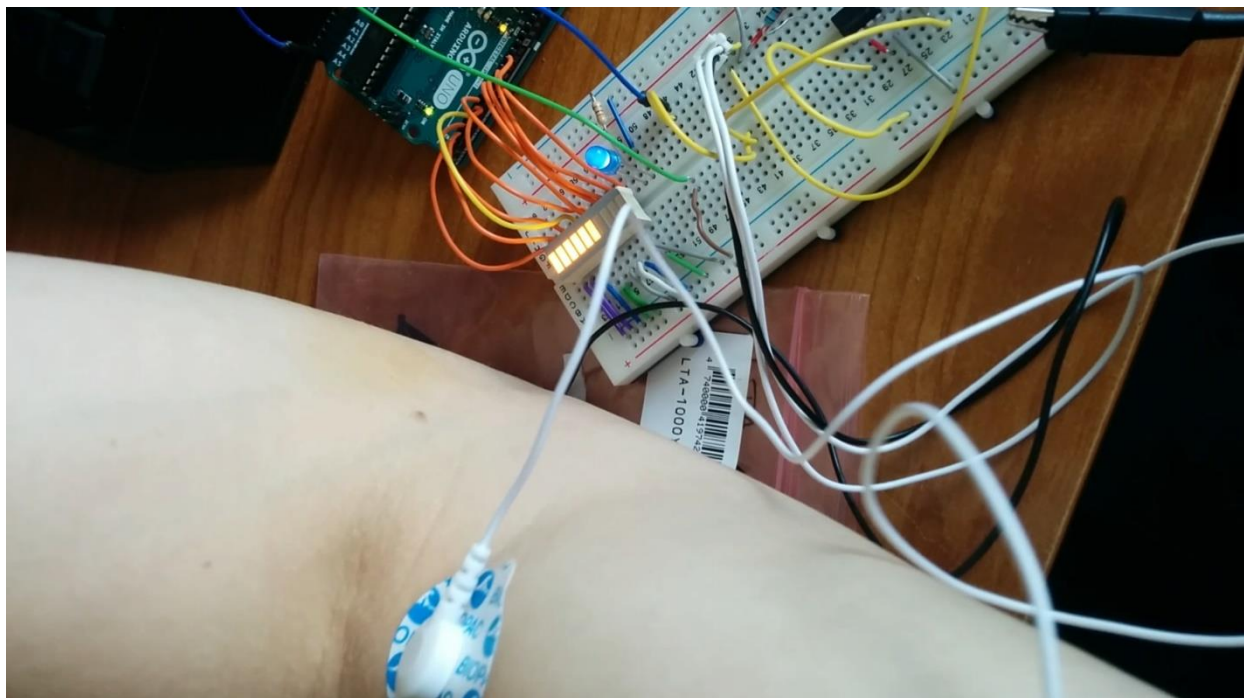
Joonis 15. LED indikaatori tulemus keskmise pingutusega.
