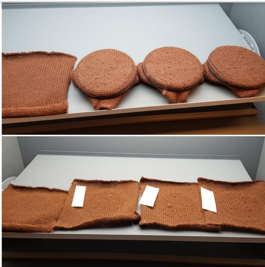
Joonis 39. Wile farm Boliivia lõngast tööproovide pillingukalduvuse hindamine valguskapis. [autori foto]
