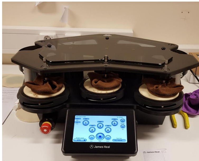
Joonis 38. Martindale katseseade pillingukalduvuse hindamiseks [autori foto]
