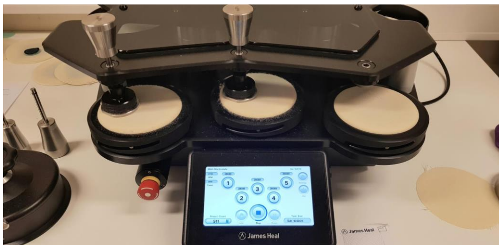
Joonis 40. Martindale hõõrdeseade hõõrdekindluse määramiseks [autori foto]
