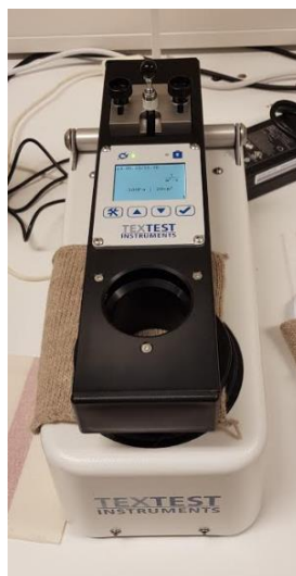
Joonis 36. Õhu läbilaskvuse määramiseks kasutatav seade FX 3340 MinAir [autori foto]
