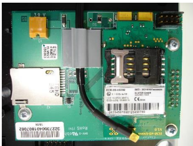
Joonis 3.7 Leppekogusemõõturi EK280 SIM-kaardi pesa ja modem [33]
