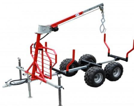
Sele 2.1. Timber Trailer IB 1000 koos kraanaga ja vintsiga
