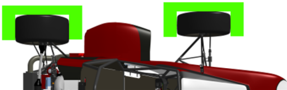
Sele 4. Rohelisega on märgitud alad kuhu ei tohi aerodünaamilisi detaile projekteerida [6]
