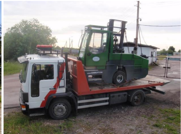
Sele 1.1.5. Laotõstuki pukseerimine
