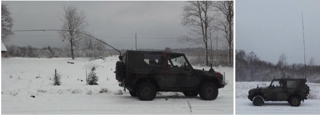
Joonis 36. Sõiduki antennide asendid – horisontaalne ja vertikaalne varrasantenn
