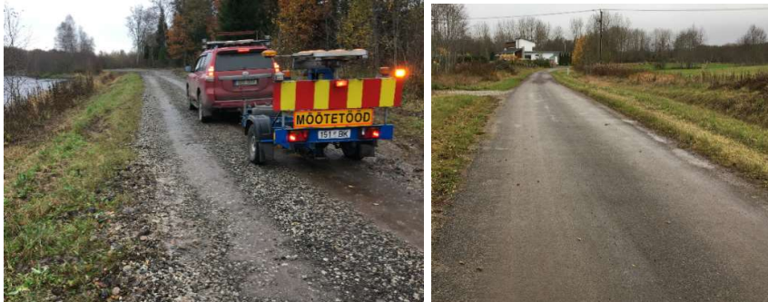
Fotod 3.10 ja 3.11. Veskitaguse tee oli nõrga kandevõimega kruusatee, mille katteks oli freespuru. Mõned mõõtepunktid võeti ka pinnatud seksioonidelt.
