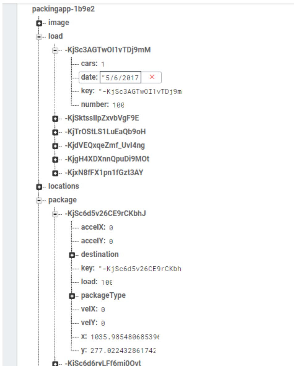
Joonis 2 Andmebaasi puu struktuur näiteandmetega
