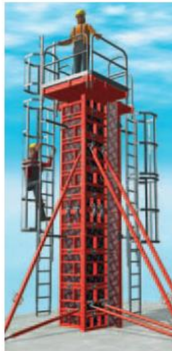
Joonis 5.3 Kandiliste postide raketamine Trio TRS kandilise postivormiga
