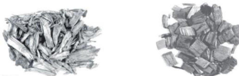
a) Hakkpuit (peenestatud terava löikeriistaga) b) Purustatud puit (purustatud nüri löikeriistaga)
