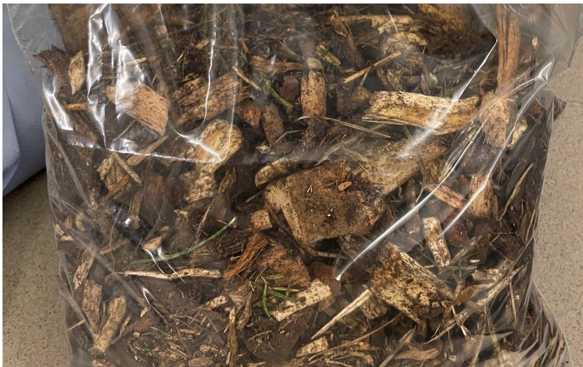
Joonis 3.2: VÄO KTJ 1 sissesöötjast võetud hakkpuidu kütuseproov
