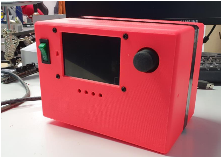
Joonis 3.7 Juhtsüsteemi korpus koos elektroonikaga.
