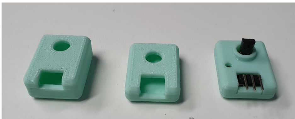
Joonis 3.4 Temperatuuri andurite korpuste arenduse käigus loodud variandid.
