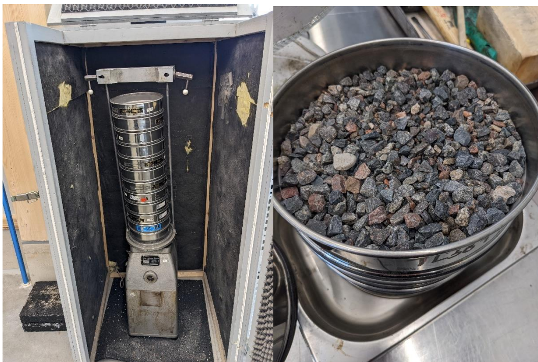
Joonis 4.3 Mehhaaniline sõelumine (erakogu)
