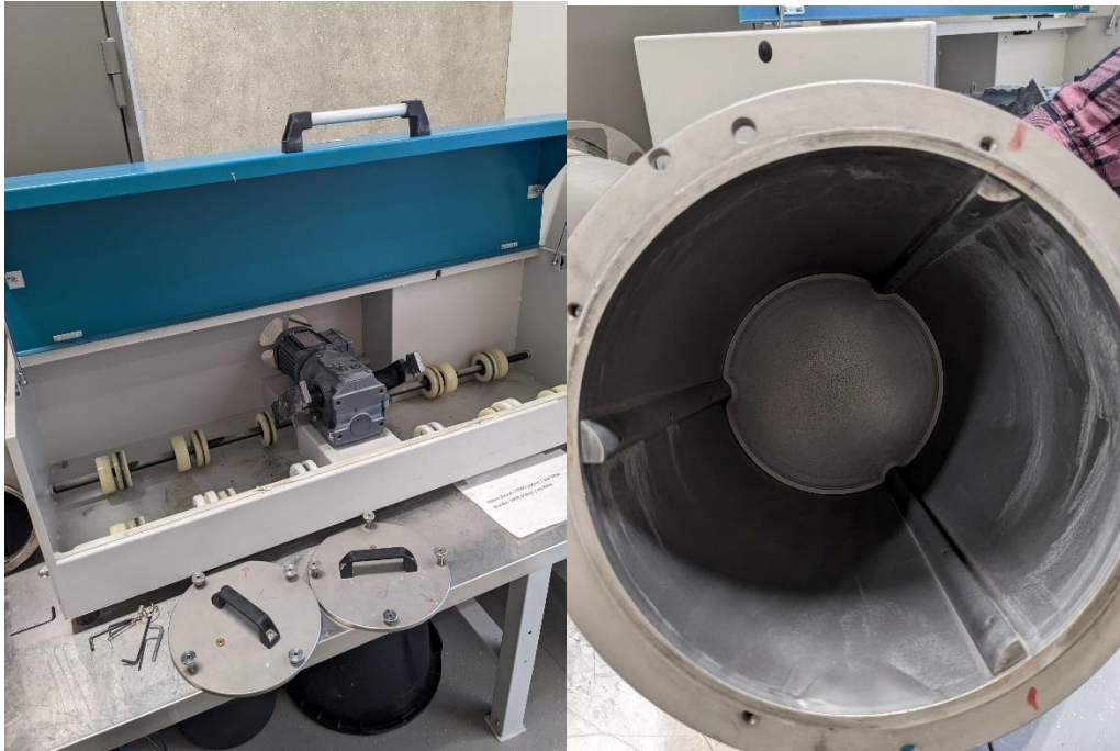
Joonis 4.6 Kulumiskindluse määramiseks kasutatav seade (erakogu)
