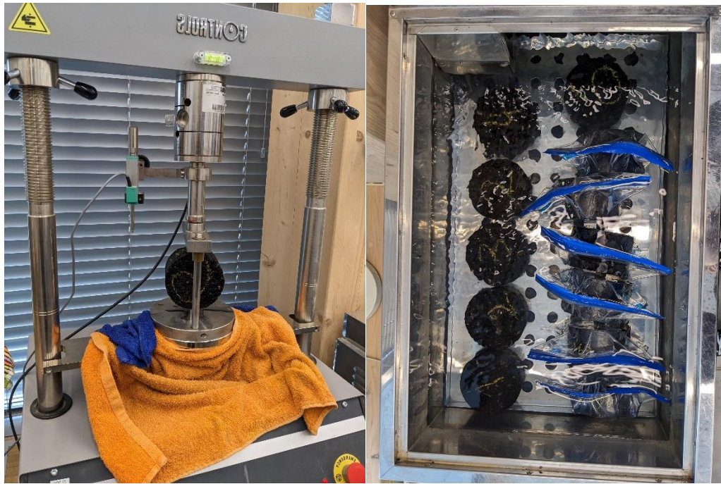
Joonis 4.9 Veepüsivuse määramine (erakogu)
