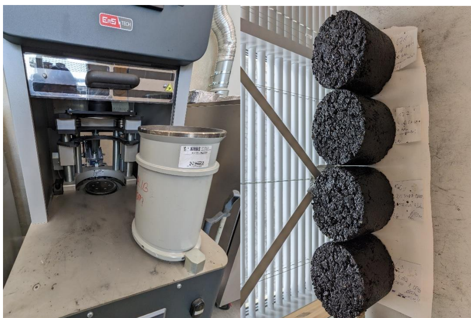
Joonis 4.8 Guraatortihendamise seade ning valmistatud katsekehad (erakogu)
