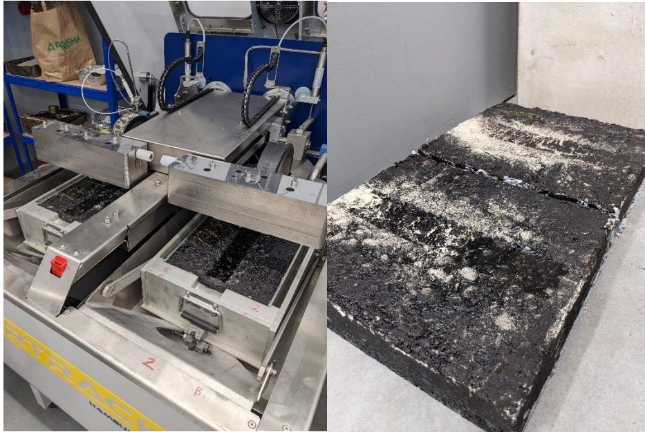
Joonis 4.10 Deformatsioonikindluse määramine väikse seadmega õhu keskkonnas (erakogu)
