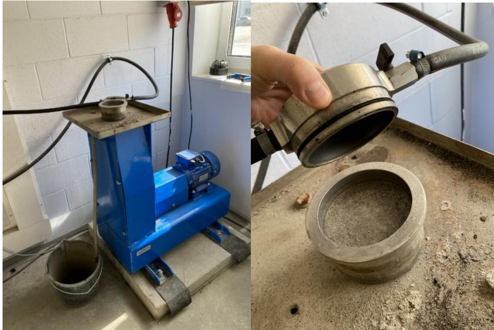
Joonis 4.11 Kulumiskindluse katsetamiseks kasutatav aparatuur (erakogu)
