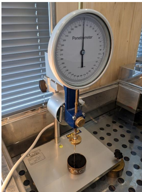
Joonis 4.4 Nõelpenetromeetriga katseproovi penetratsiooni määramine (erakogu)
