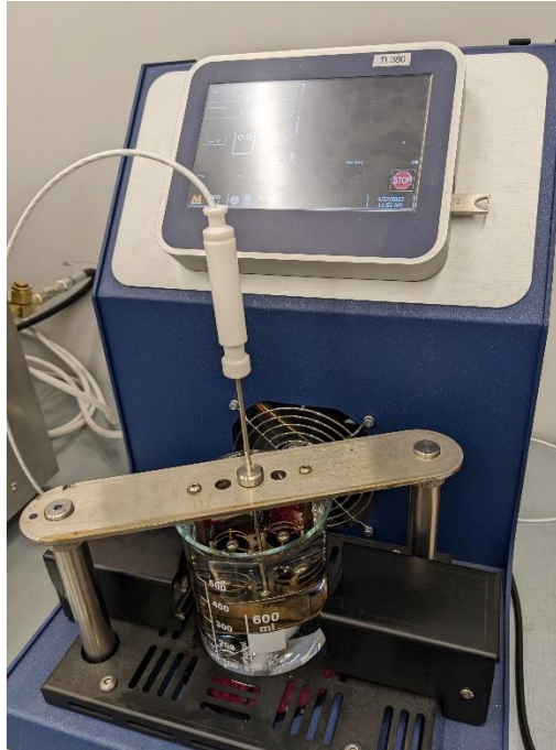
Joonis 4.5 Kuuli-rõnga meetodil pehmenemistäpi määramine (erakogu)
