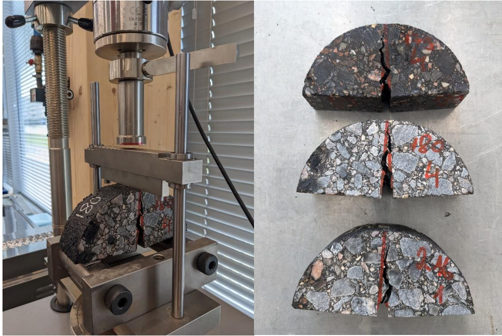
Joonis 4.12 Pragunemistugevuse määramine (erakogu)
