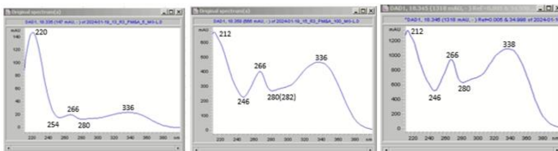
Joonis 17. Apigeniini kalibratsioonispektrid: 5 mg/L vasakul, 100 mg/L keskel ja 250 mg/L paremal
